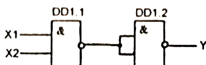
Рис. 3.9.1. Элемент И, составленный из двух элементов 2И-НЕ.
